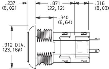
**W** 6 TUMBLER TUBULAR LOCK WITH ANTI-STATIC SWITCH
